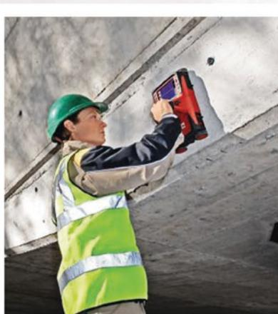
Un efficiente aiuto per l'ispezione e la valutazione delle strutture in cemento armato (prima foratura)
